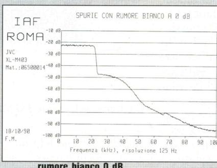
*Pressoché immacolato lo spettro dei 20 kHz/0 dB, ad eccezione di una piccolissima dose di seconda e terza armonica. Nella norma il decadimento spettrale del rumore bianco, il cui andamento farebbe supporre l'esistenza di una energica filtrazione analogica oltre i 40 kHz.*
